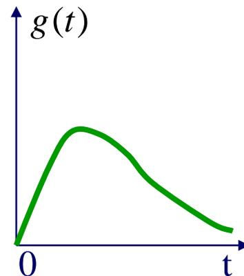
阶跃响应包括齐次解和特解，**特解为常数**。也可以根据**线性时不变系统的特性**，**利用冲击响应与阶跃响应的关系**求阶跃响应。
