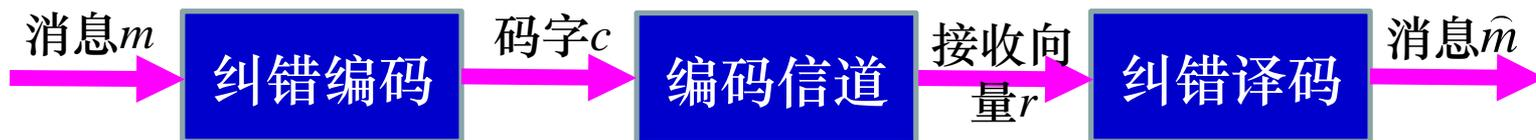
FEC方式差错控制系统模型
